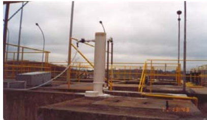
FOTOGRAFIA Nº 10. TESTE COM UMA TORRE (150 MM X 750 MM) DE TABLETES DE ÁCIDO TRICLOROISOCIANÚRICO.
